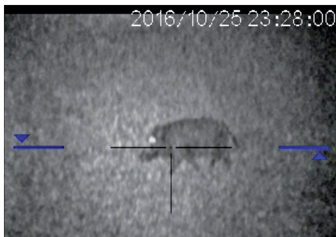
Obr. 4: Divočák pozorovaný přístrojem se zapnutým přísvitem. Šipky na okraji snímku upozorňují, že lovec nedrží zbraň ve vodorovné poloze.
